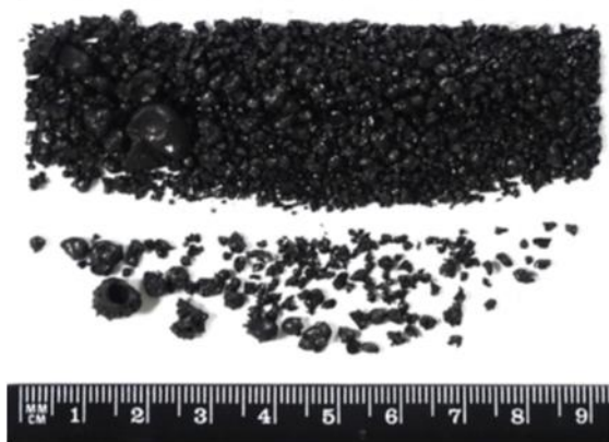
Fig. 2 – Composición química y aspecto de las escorias de cobre empleadas en este trabajo
