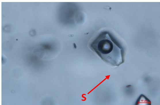
Fig.2 – Exemplo de inclusão fluida primária em forma de cristal negativo com uma fase sólida (S)
