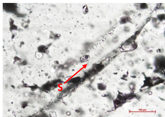
Fig. 4 – Exemplo de uma inclusão fluida secundária de maior dimensão exibindo uma fase sólida (S) de halite.
