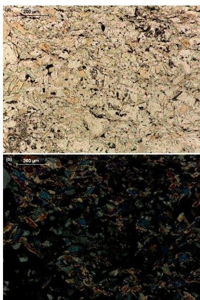
Fig. 3 – Textura da amostra BJ848, em nicóis paralelos (a) e em nicóis cruzados (b).
